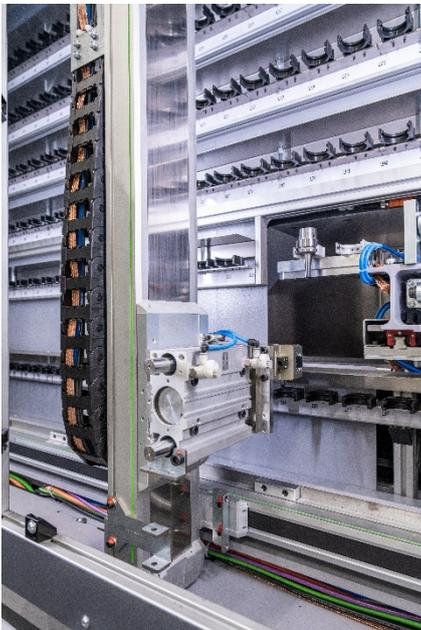
Bei der Konfiguration von HIWIN-Achssystemen sind Anwender flexibel: Von einem in Millimeterschritten frei wählbaren Hub, stehen auch eine Vielzahl von Optionen bereit, beispielsweise Energieketten, Endschalter sowie eine Antriebsadaption inklusive Getriebe, passend für jeden Motortyp.
